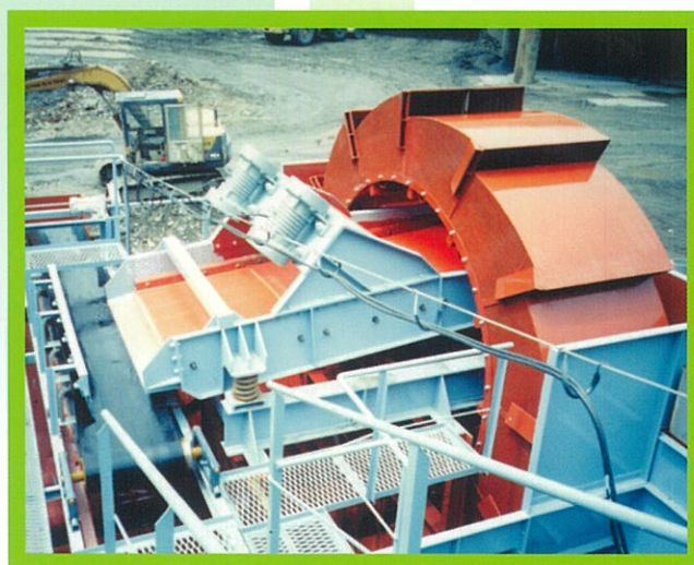
プール上に設置された水切篩 (コンパクト化)
